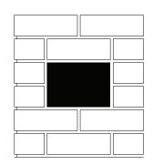
SLEEVE FITS INTO 1 BRICK WIDE BY 2 BRICK HIGH CAVITY
